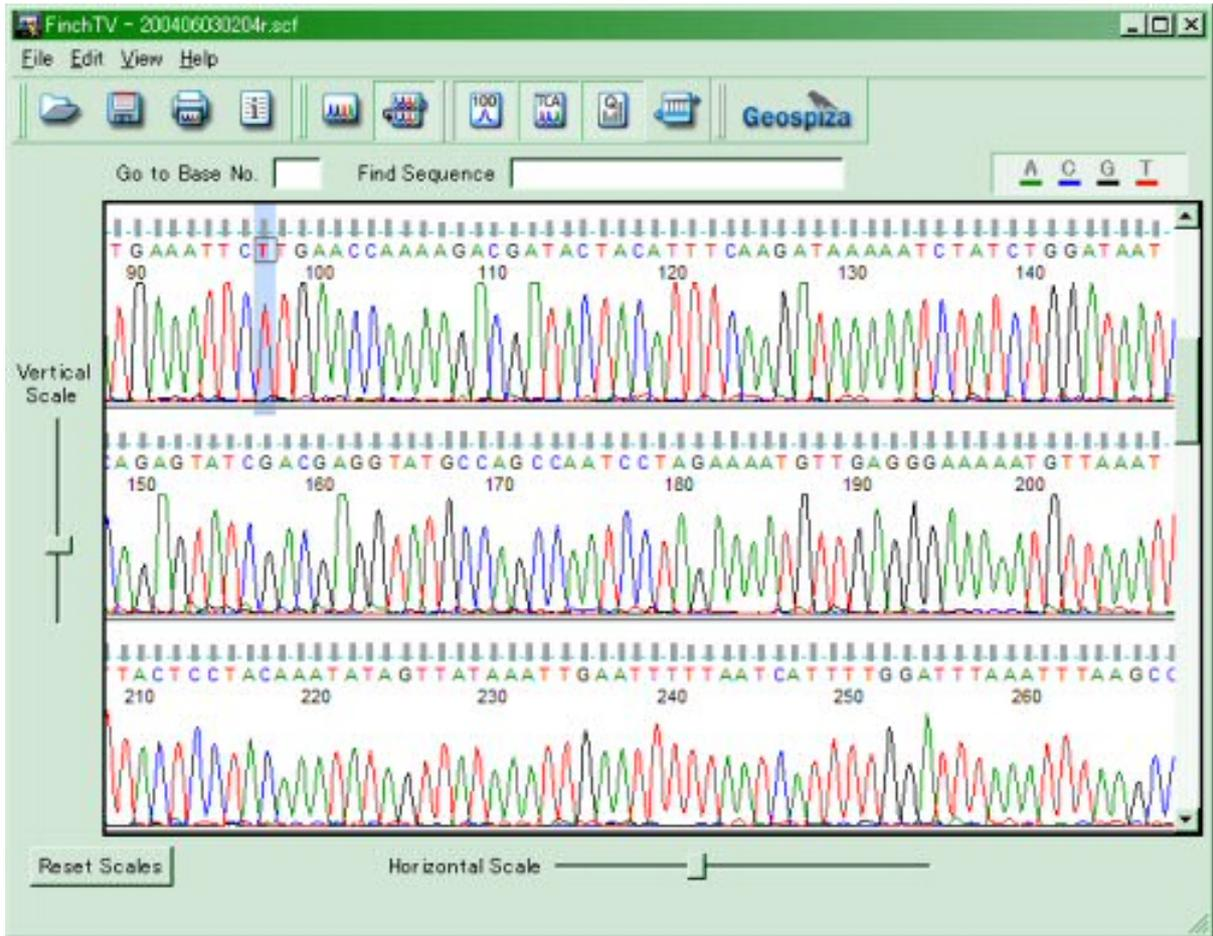
波形の上にベースコールの結果の塩基、その上に信頼性を表す棒グラフが表示されている。縮小しているため見えなくなっているが、信頼性が十分か不十分かの基準となる線も表示されている。その線よりも棒グラフが高いデータはほぼ見直す必要が無い。FinchTVでは水平方向・垂直方向のスケールを下と左のバーで独立に変更することができる。手動で修正した塩基にはアンダーラインが付く。標準では1段表示だが「View Wrapped View」で折り返し多段表示に変更できる。
